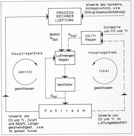
Bild 1. Struktur der Lüftungsregelung
