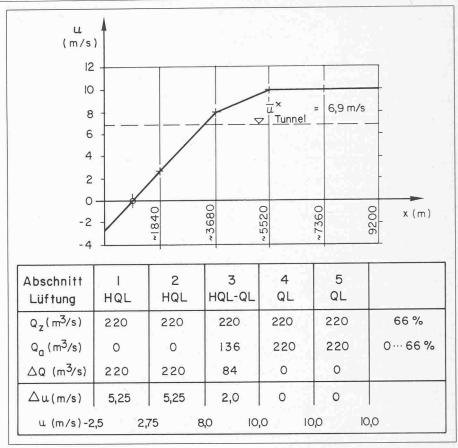
Bild 4. Beispiel eines Längsgeschwindigkeitsverlaufes (bei etwa 1800 PWE/h mit 80 km/h)
