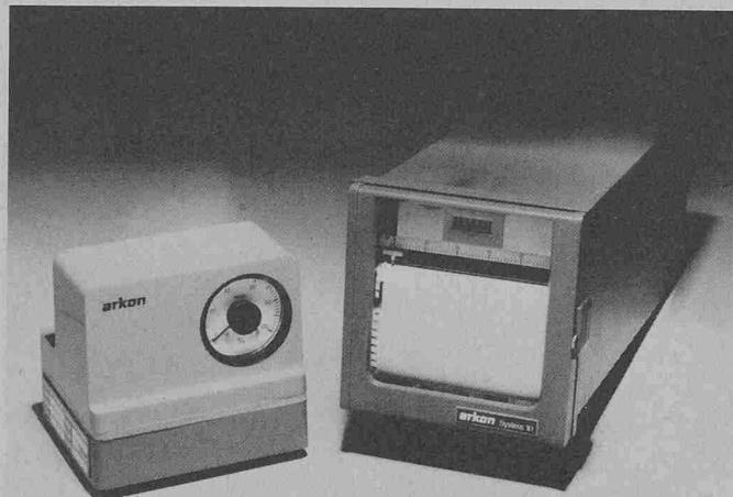
Zum Messen von Niveau und Durchflussmengen wird, wie schon bei den bisherigen mechanischen Arkon Instrumenten, Luft in ein Tauchrohr geblasen (Einperlsystem). Der dabei ent-
