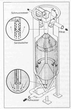
Bild 1. Schnitt durch ein DynaSand-Filter
