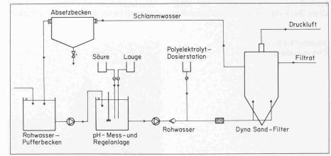
Bild 4. Abwasserreinigung für Galvanik-Abwasser
