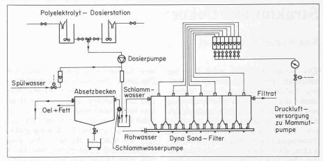
Abwasserreinigung für ein Stahlwerk
