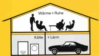
VETROFLEX PB wird direkt unter die Decke geklebt oder auf einer Holzlattung befestigt.
