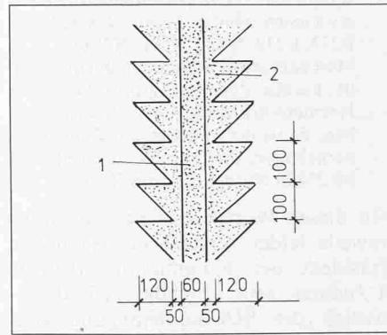
Bild 2. Detail B. Anordnung mehrerer Stufen der Kerndichtung in der Sperrre
