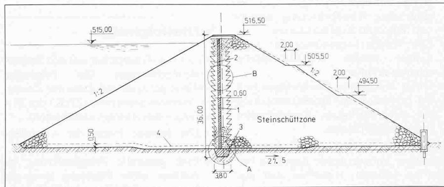
Bild 1. Musterquerschnitt einer Sperrre aus Lockermaterial mit Kerndichtung aus Asphaltbeton
