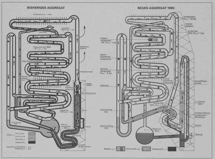
Der Hauptunterschied zwischen dem bisherigen und dem neuen Absorber-Aggregat eines Sibir-Kühlschrankes liegt darin, dass die Rektifikations-Wärme, die bisher am Wasserabscheider nutzlos nach aussen abgeführt werden musste (Pfeile Schema links), nunmehr dem Funktionsprozess wieder zugeführt werden kann (Energie-Recycling)
