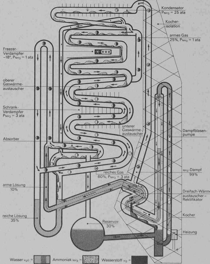
Der Hauptunterschied zwischen dem bisherigen und dem neuen Absorber-Aggregat eines Sibir-Kühlschranks liegt darin, dass die Rektifikations-Wärme, die bisher am Wasserabscheider nutzlos nach aussen abgeführt werden musste (Pfeile Schema links), nunmehr dem Funktionsprozess wieder zugeführt werden kann (Energie-Recycling).
