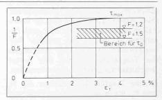
Einfluss der Grösse des Sicherheitsgrades Bild 3. gegenüber Instabilität auf die Deformationen (nach
