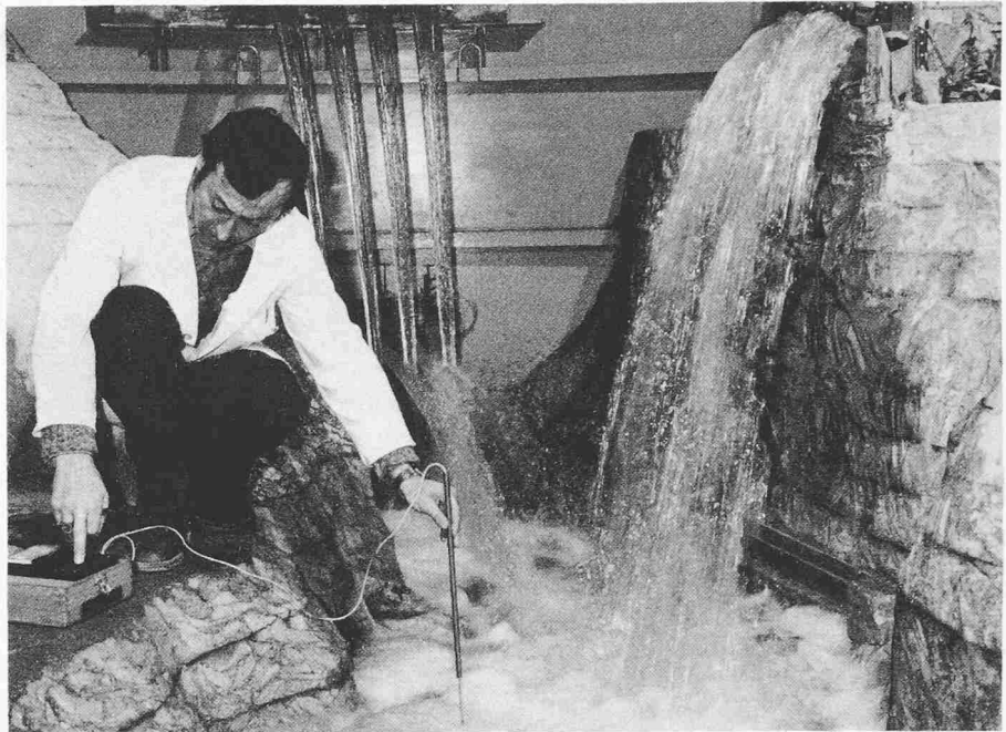
Bild 11. Hydraulisches Modell der 226 m hohen Bogenstaumauer El Cajon in Honduras. Überprüfung der Nebenanlagen, insbesondere der Hochwasserentlastung für 8500 m 3 /s durch die VAW (1979/80)
