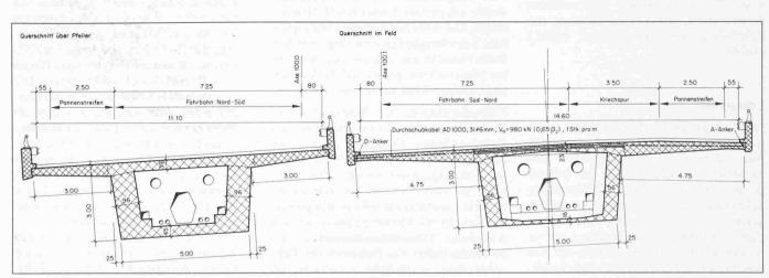
Bild 3. Querschnitte durch die Brücken Ponte a valle und Ponte a monte mit Schema für Quervorspannung
