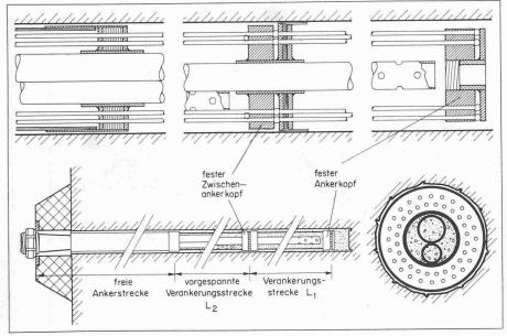
Bild 8. Spezialanker G, mit vorgespannter Verankerungsstrecke L2 und Verankerungsstrecke L1
