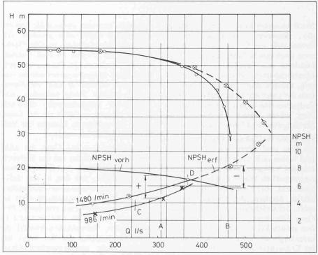
Bild 11. Einfluss der NPSHvorh auf die Drosselkurve.
