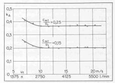
Bild 8. Abhängigkeit der Kavitationszahl k<sub>A</sub> von der Drehzahl und der Umfangsgeschwindigkeit am Radeintritt. Versuche mit Wassertemperatur 49,5 °C K. Graumann [4]
