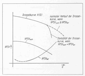
Bild 7. Einfluss der NPSHvorh auf die Drosselkurve
