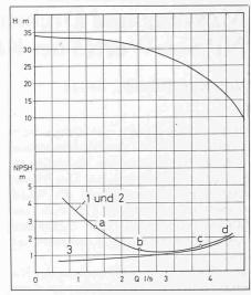
Bild 5. NPSH-Werte bei:
