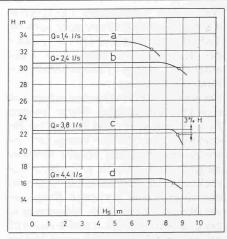
Bild 4. Kavitationsversuch durch Änderung des Saugwasserspiegels nach Bild 1 NPSH bei 3% Förderhöhenabfall
