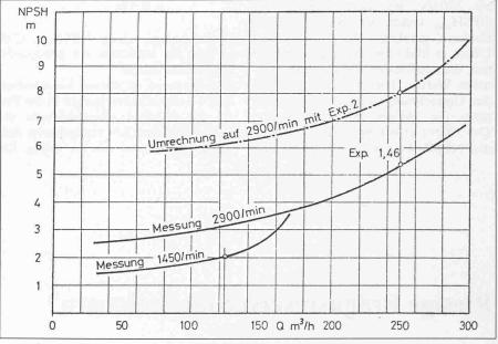
Bild 10. NPSH-Versuchswerte bei 1450 und 2900/min Den ausgezogenen Versuchswerten, die für  $Q_{opt}$  einen Umrechnungsexponenten 1,46 ergeben, sind strichpunktiert die theoretischen Werte mit Exponent 2 gegenübergestellt
