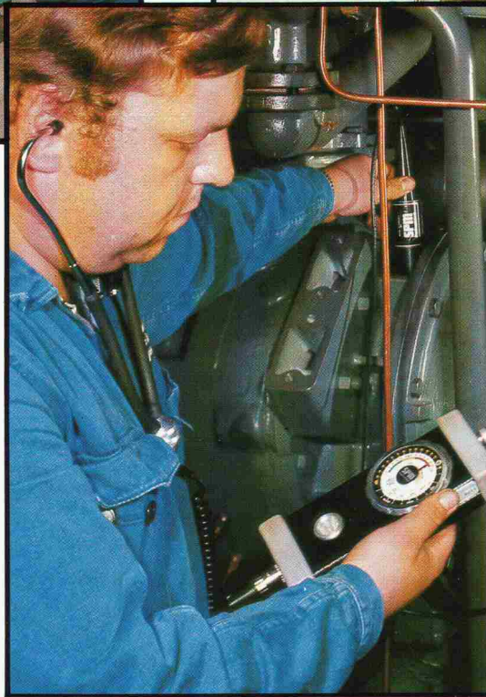
ZR-PACK Oelfreier Schraubenverdichter, Zustandsmessung der Elemente
