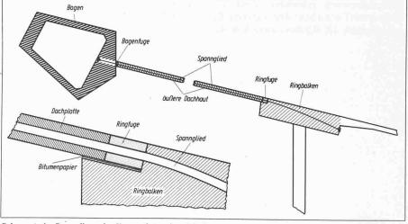
Schematische Darstellung der Konstruktion des südlichen Aussendachs (Querschnitt) der Berliner Kongress-
