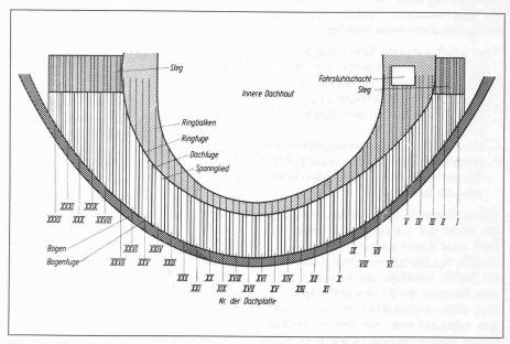
Schematische Darstellung der Konstruktion des südlichen Aussendachs (Aufsicht) der Berliner Kongresshalle
