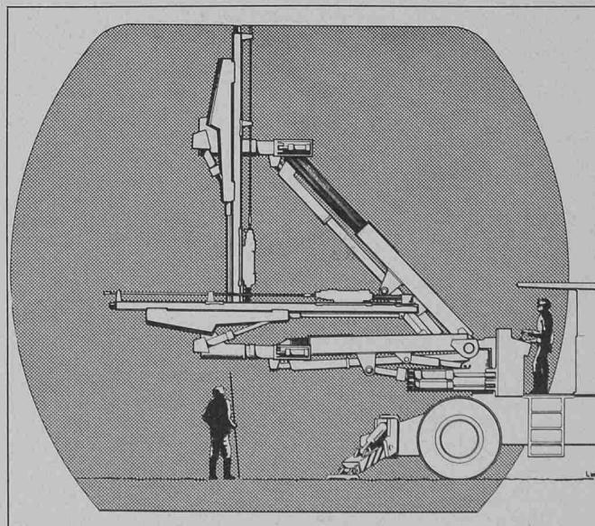
Fa. Normet verwendet. Ein 6-Zylinder-Dieselmotor mit 74 kW Leistung verleiht dem etwa. 35 t schweren Fahrzeug eine Steigungsfähigkeit von 30%. Je
