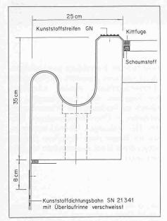
Detail der Ausführung der Abdichtung bei der Überlaufrinne. Zuerst wurde ein mit Sarnafil-Kunststoffdichtungsbahnen kaschiertes Chromstahlblech, das der Form der Überlaufrinne angepasst war, eingelegt. An diese Kaschierung wurde die KDB an den senkrechten Wänden angeschweisst und in der Ecke Wand/Boden vertikal gespannt. Auf der Krone der Rinne wurde ein rutschsicheres, genopptes KDB-Band aufgeschweisst
