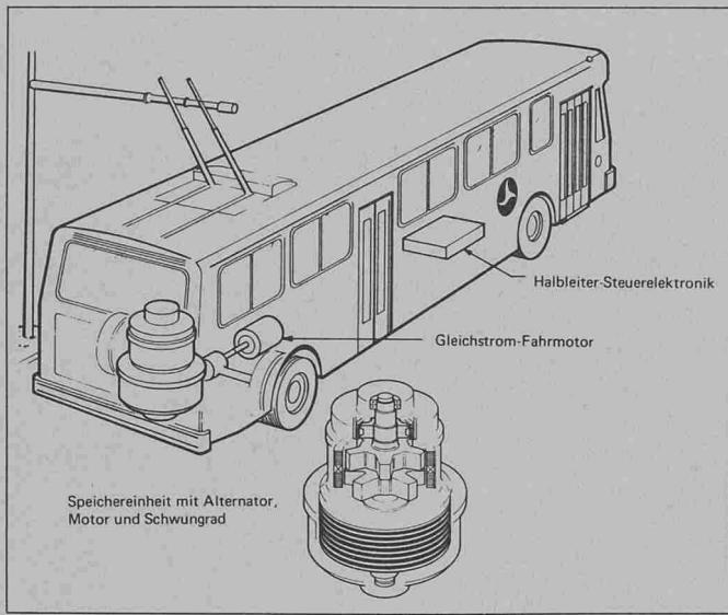
des Antriebs bildet ein 1400 Kilogramm schwerer Stapel von Stahlscheiben. Dreht dieser sich in der Minute 5000 bis 10 000 Mal, liefert er genug Energie, um das 12,7 Tonnen wiegende, vollbesetzte Fahrzeug im Stadtverkehr über fünf bis sechs Kilometer in Bewegung zu halten. Am Ende dieser Strecke, die für den innerstädtischen Busbetrieb erfahrungsgemäss ausreicht, wird das Schwungrad in 90 Sekunden wieder auf volle Drehzahl gebracht.
