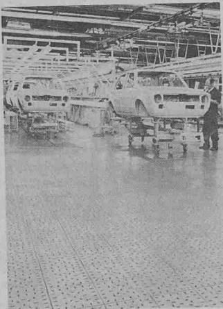
rende Reparaturen werden vermieden. Zerstörte Betonfugen können mit den Ankerplatten saniert werden. Das Bild zeigt einen Bodenbelag mit Stelcon-Ankerplatten in der Schwerindustrie. Hier werden relativ hohe Gewichte auf kleinen Flächen bewegt und abgestellt.
