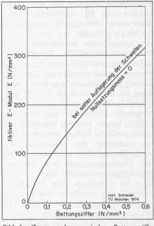
Bild 3. Zusammenhang zwischen Bettungsziffer und fiktivem E-Modul
