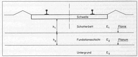
Bild 2. Bodenaufbau unter dem Gleis
