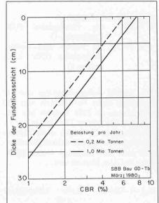
Bild 7. Dicke der Fundationsschicht in Neben-, und Verbindungsgleisen unter Holz- und Stahlschwellen mit Schienenprofil SBB I
