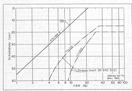
Bild 8. Vergleich der Fundationsschichtdicke Gleis-Strasse
