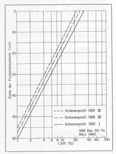
Bild 6. Dicke der Fundationsschicht in Hauptgleisen unter Einblockbetonschwellen
