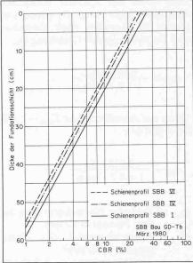
Bild 5. Dicke der Fundationsschicht in Hauptgleisen unter Zweiblockbetonschwellen
