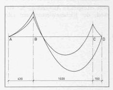
Bild 11. Systemänderung durch Wegfall einer Stütze eines Dachträgers. Momentenverlauf vor und nach Entfernung der Stütze C; Klebearmierung zwischen Stützen B und D
