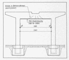
Bild 12. Mit Klebearmierung sanierte Betonrahmen des ALBA Aluminium Schmelzwerkes in Bahrain
