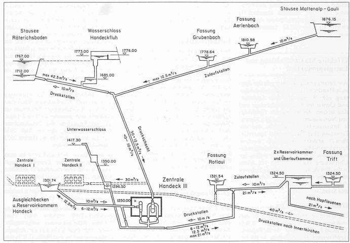
Kraftwerke Handeck III: Hydraulisches Anlageschema
