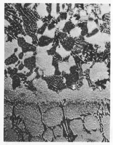
Dieselmotorauspuffventil mit gepanzerter Sitzfläche: Auf die Stellitunterlage (Kobaltbasis mit Chrom-Wolfram-Karbid-Netzwerk) ist eine Superlegierung als Korrosionsschutzschicht (oben) aufgespritzt. Um das Mikrogefüge im Farbkontrast sichtbar zu machen, wurde die Verbindungszone im Vakuum mit Zinkselenid bedampft
