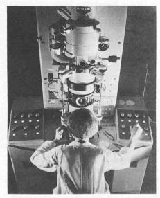
100-kV-Elektronenmikroskop mit einem Auflösungsvermögen von 5 Å
