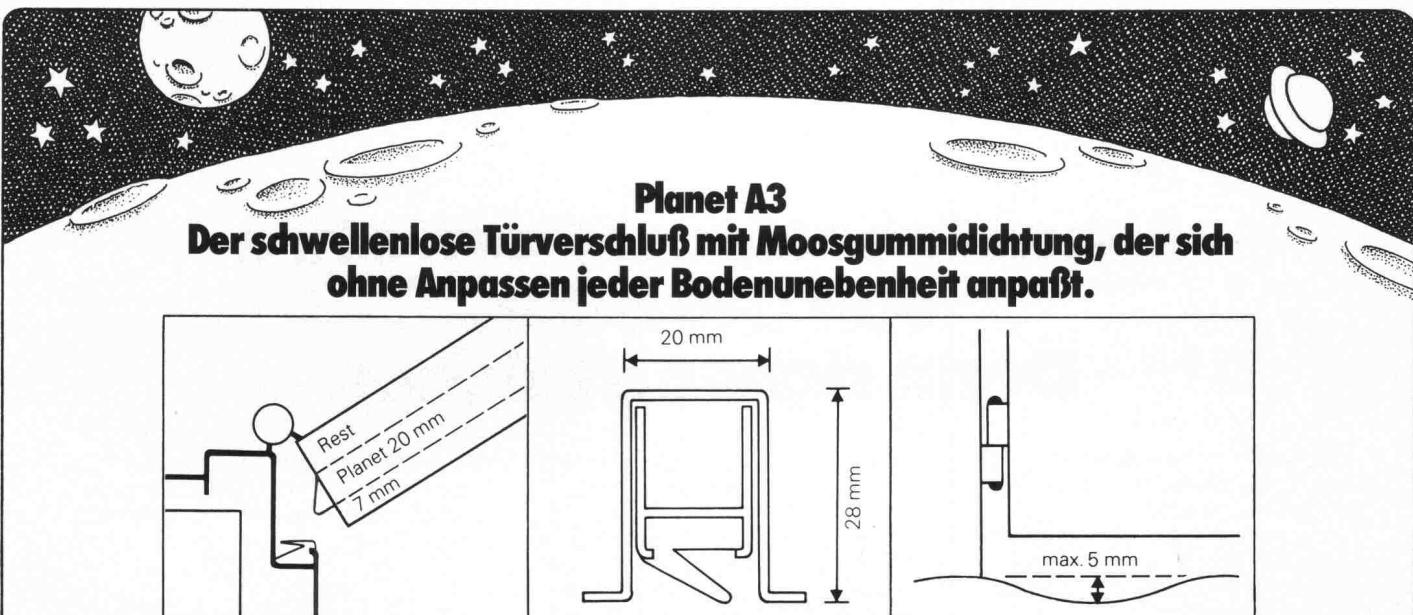
(Für stumpfeinschlagende Türen oder Türen mit mindestens 26 mm Falz.) Das bedeutet: Da wird Bodenanpassung auch bei Natursteinböden und Böden in Altbauwohnungen überflüssig. Abstand zwischen Türe und Boden 5–18 mm. Nut, 28 mm tief, 20 mm breit, Abstand laut Zeich-
