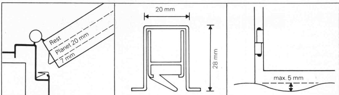
(Für stumpfeinschlagende Türen oder Türen mit mindestens 26 mm Falz.) Das bedeutet: Da wird Bodenanpassung auch bei Natursteinböden und Böden in Altbauwohnungen überflüssig. Abstand zwischen Tür und Boden 5-18 mm. Nut, 28 mm tief, 20 mm breit, Abstand laut Zeich-
