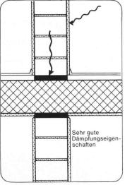
Pronouvo 1073 vermag grosse Lasten zu übertragen und ist auch hochbelastet ein wirkungsvolles Körperschall-Isoliermittel.
