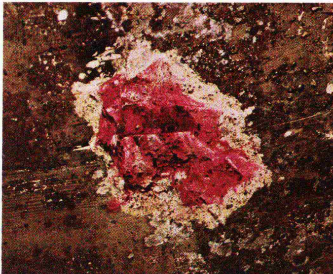
Brücke B. Die rote Färbung von Beton und Eisen zeigt, dass die Stahleinlage noch vollständig in der alkalischen Zone des Bauwerkes liegt
