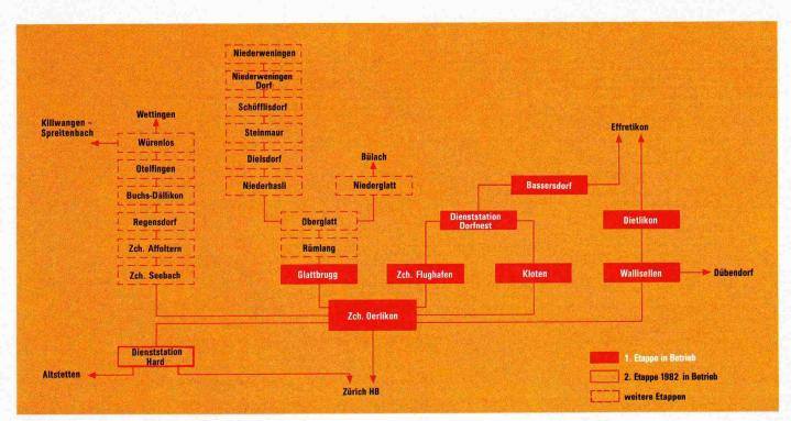
Bild 1. Fernsteuerzentrum Zürich Oerlikon. Schema und Ausbauetappen
