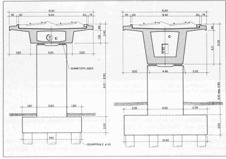
Querschnitte durch den Viadukt der Klotenerlinie bei den Pfeilern Nr. 7 und Nr. 8 Bild 9.
