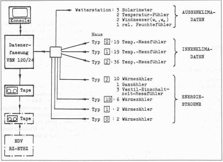
Bild 9. Messsystem und Zusammenstellung der Messgrössen
