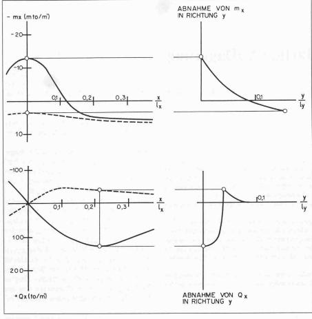
Bild 2. Schnittkraftverlauf in x-Richtung
