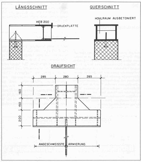
Bild 5. Konstruktive Ausbildung der Übergangskonstruktion
