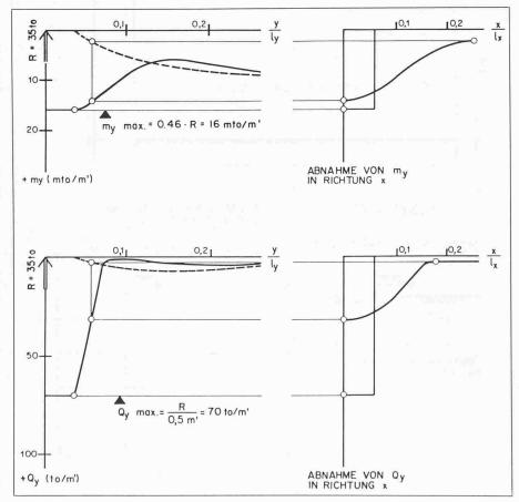
Bild 3. Schnittkraftverlauf in y-Richtung
