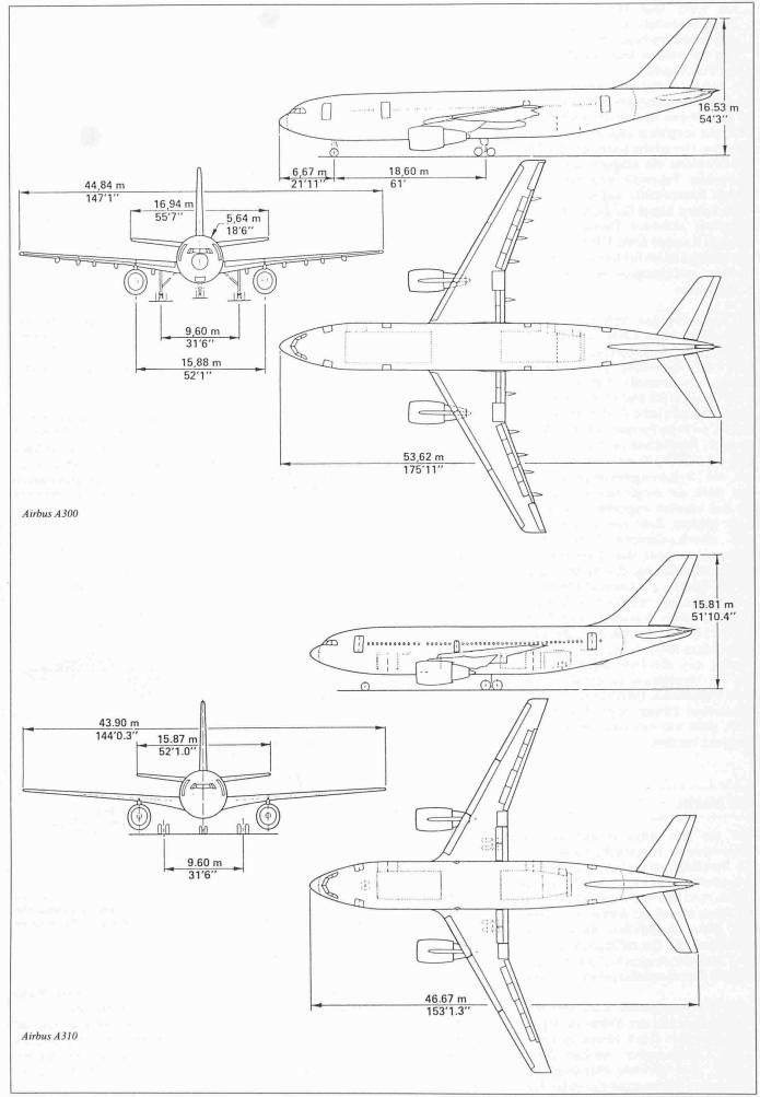
Vergleich zwischen dem Airbus A300 und dem Airbus A310. Obwohl mit Ausnahme der Abmessungen äusserlich nur geringe Unterschiede feststellbar sind, ist der Flügel des A310 eine weitgehende Neukonstruktion
