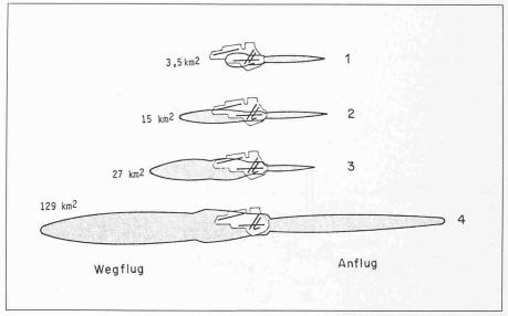
Ein Vergleich der Lärmausbreitung beim Start mit der Kontur ≥ 90 EPN(dB) auf dem Flughafen Paris-Orly zeigt den grossen Vorteil des Airbus auch in bezug auf den Umweltschutz. Für die Anwohner von Kloten wird der bei der Swissair bevorstehende Schritt von der DC-8 zum A310 eine wesentliche Entlastung bringen.
