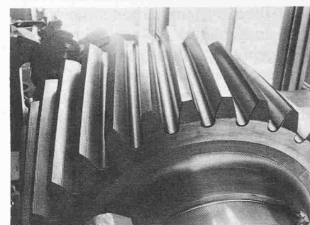
Bild 23B. Detail der Verzahnung eines Zahnritzels mit einer Zahnbreite von 800 mm und mit einsatzgehärteter und geschliffener Verzahnung bestimmt für ein Maag-Getriebe zum Antrieb eines Warmwalzwerkes für die Stahlwerke Hoogovens. Man beachte die im Bild gut sichtbare sorgfältige Ausrundung (Protuberanz) des Zahngrundes. Zähnezahl (z): 31, Modul (m): 35, Zahnbreite (b): 800 mm und Zahnschräge = 10^\circ 30' . Festigkeit des Zahnkranzmaterals 120–130 kg/mm 2 . Strahlintensität beim Shot-peenen gemessen nach Almen-Test A 2 = 11,0 Mikroiinch = 0,28 mm.
