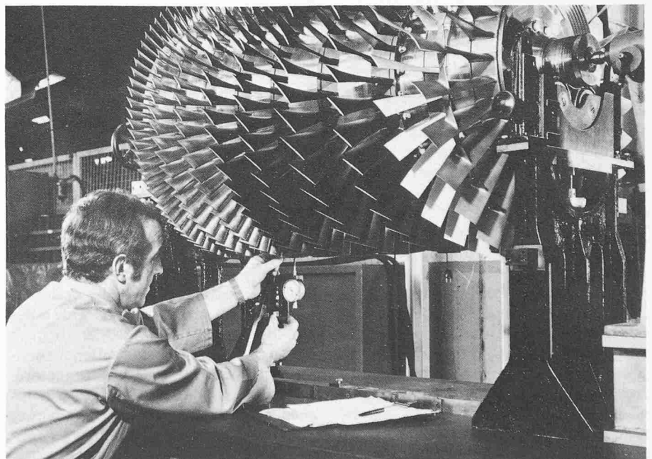
Bild 25. Beschaukelung des Kompressors des zum Antrieb des Düsenjägers «Mirage» von der «SNECMA» entwickelten Triebwerkes ATAR (Bei der im Bild gezeigten Ausführung handelt es sich um eine in Europa ausserhalb der Schweiz gebaute Variante)[15]
