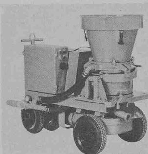
Die vielfältigen Forderungen können mit dieser Neukonstruktion in bisher nicht erreichter Weise erfüllt werden. Es sind die folgenden Verbesserungen erreicht worden: Verminderung des Rückpralls, Eliminierung von Staub an der Maschine und beim Düsenführer, höhere und konstante Leistung auch bei ungünstigen Ausgangsmischungen (z. B. hohe Eigenfeuchtigkeit), Reduktion des Verschleisses, einfacher und sicherere Bedienung, Reduktion des Reinigungs- und Serviceaufwandes.
