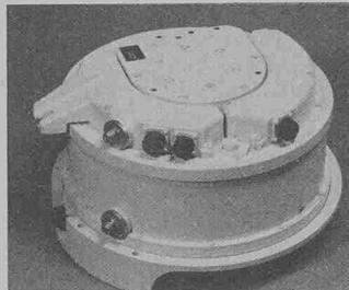
auch für Bagger, Kranwagen, mobile Hebebühnen und ähnliche Maschinen. Es hat zwei Hydraulikanschlüsse, NW 16, für max. 175 bar, einen Leckölanschluss, NW 10, sowie 23 elektrische Anschlüsse für jeweils max. 50 Amp. Die maximal zulässige Drehzahl beträgt 25 min<sup>-1</sup>; das erforderliche Drehmoment bei 175 bar liegt unter 50 Nm. Der Aussendurchmesser beträgt 430 mm.
