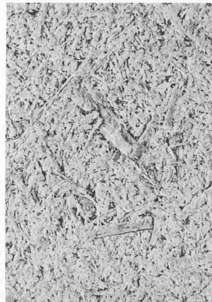
Bild 7. Nahaufnahme der Oberflächenstruktur (3fache Vergrößerung) bei den Schallschutzwänden (Bild 6, Seite ?). Die Platten weisen keine Oberflächenbehandlung (Anstrich, Verputz usw.) auf
