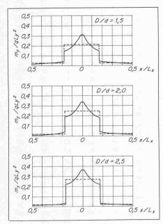
Bild 5. Querverteilung des Biegemomentes  $m_y$  in Stützenachse, Schnitt A-A. Vergleich mit dem «Näherungsverfahren».  $L_y$  =  $L_X$
