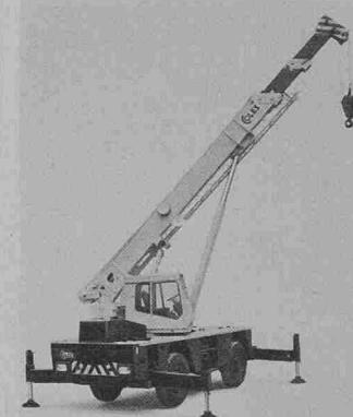
Der Coles 25 T Transit besitzt nur eine Fahrerkabine mit allen Bedienungshandgriffen und Kontrollinstrumenten für Fahr- und Kranarbeit. Sie ist am Kranoberwagen angeordnet und für Kranarbeit oder Strassenfahrt um 180° schwenkbar. Der Aufbau einer einzigen Kabine hat den Vorteil, dass bei der Kranarbeit Kabinenbeschädigungen durch die Last verunmöglich werden.
