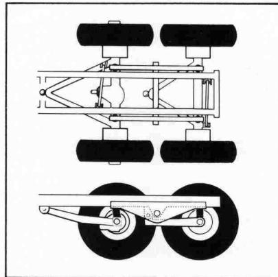
Räder folgen jeder Unebenheit, so dass die volle Zugkraft auf den Boden kommt. Dank Tandemachse und Knickgelenk
