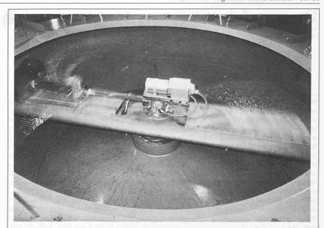
Im Zentrum des rotierenden Propellers der Versuchsanlage ist die Videokamera (Bildmitte) montiert. Sie hält die Bewegung des Wassers fest, das die am äusseren Ende des Propellers fixierte Gasturbinenschaufel (links) durchfliesst und an ihrer Hinterkante verlässt.
