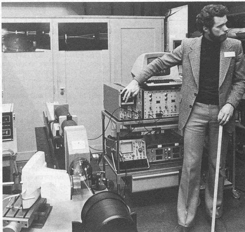
Die Methode der Laser-Doppler-Anemometrie wurde in einer Demonstration mit Hilfe eines gewöhnlichen Ventilators (im Bild links vorne) veranschaulicht. Rechts neben der Laser-Apparatur (Bildmitte) ist die Auswertelektronik aufgebaut.
