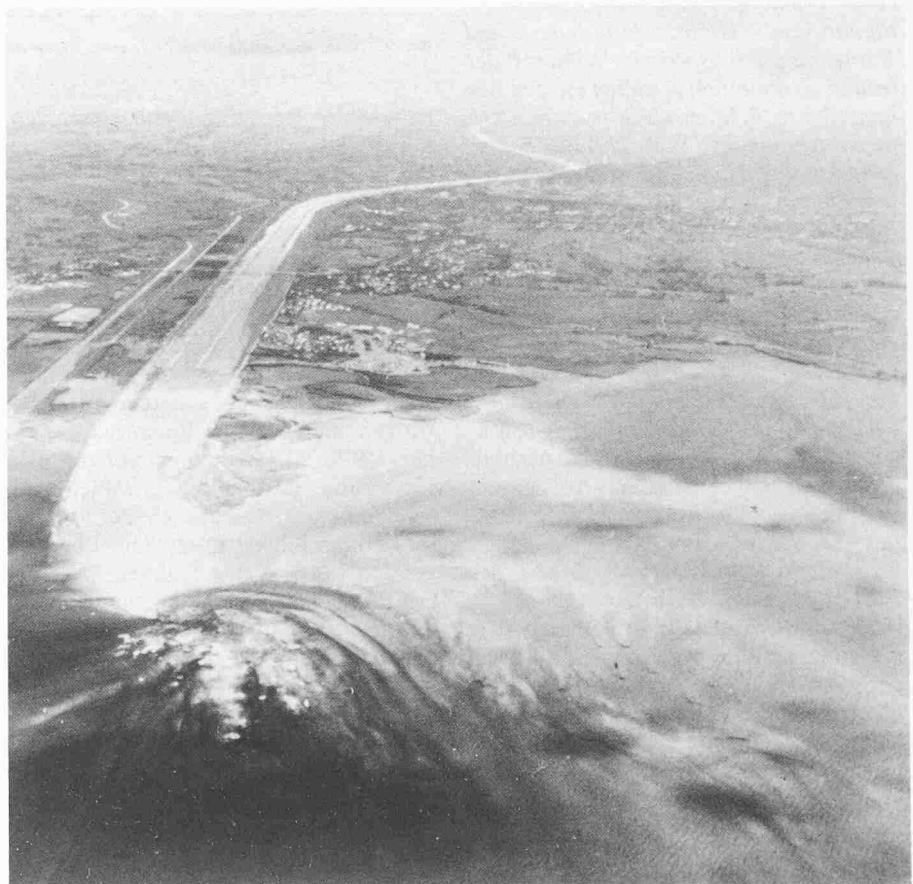
Bild 8. Einmündung des Rheins in den Bodensee bei Hochwasser. Der Grossteil der Schwebstoffe lagert sich unmittelbar beim Eintritt in den See ab, der Rest wird seitwärts verdriftet
