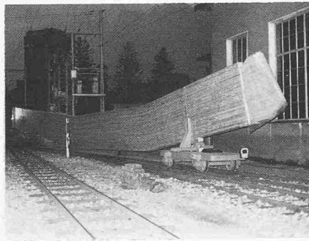
*Bahn (RhB)* besorgt, die dank betrieblicher Flexibilität (mehrere Profilfahrten; nächtliche Sondertransporte) und technischer Anpassung (Tieflade/Dreh-schemel-Wagenpaar) die anforderungsreiche Aufgabe zu lösen wusste. Schliesslich gelangten die Träger mittels *Langholzlastwagen* zur Baustelle, wo sie (Stichbogen nach oben) auf acht speziell eingerichteten Lagerplätzen deponiert wurden.
