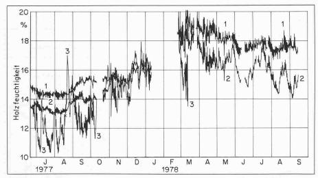
Bild 6. Zeitverlauf der Holzfeuchtigkeiten hei direkter Bewitterung in Längsmitte des Messbalkens. Kurve 1: in 80 mm Querschnittstiefe Kurve 2: in 40 mm Querschnittstiefe Kurve 3: in 10 mm Querschnittstiefe (nur etwa 1. Hälfte der Versuchsperiode)
