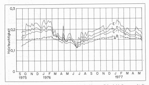
Bild 11. Zeitlicher Verlauf der volumengemittelten Holzfeuchtigkeiten von Fichtenholzbalken unterschiedlicher Abmessung L (cm) × B (cm × H cm) im Freien unter Dach Balken B 180 cm × 8 cm × 16 cm Balken C 90 cm × 4 cm × 8 cm Balken A 375 cm × 17 cm × 34 cm Balken E 22 cm × 1 cm × 2 cm Balken D 45 cm × 2 cm × 4 cm
