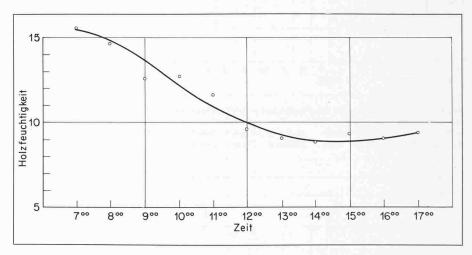
Bild 9. Zeitlicher Verlauf der Holzfeuchtigkeit an der Trägeroberfläche während einer Trocknungsphase an einem warmen Sommertag (7.7.77) bei direkter Bewitterung. Ermittlung der Holzfeuchtigkeit durch Darren von dünnen Spänen
