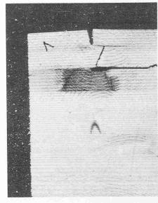
Bild 13. Lokale Fäulnis im Innern des Messbalkens, im Verlaufe eines Jahres verursacht durch Lenzites-Befall nach Durchfeuchtung im Bereich eines Risses auf der Oberseite
