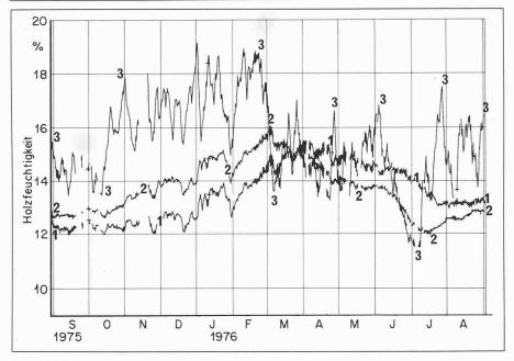
Bild 5. Zeitverlauf der Holzfeuchtigkeiten im Freien unter Dach in der Längsmitte des Messbalkens. Kurve 1: in 80 mm Querschnittstiefe Kurve 2: in 40 mm Querschnittstiefe Kurve 3: in 10 mm Querschnittstiefe
