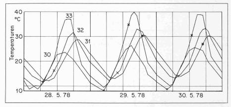
Bild 8. Verlauf der Temperaturen der Aussenluft (Kurve 30) und in Balkenlängsmitte in 80 mm (Kurve 31), in 40 mm (Kurve 32) sowie in 10 mm (Kurve 33) Querschnittstiefe an einem Sommertag bei direkter Bewitterung. Infolge Strahlungseinwirkung liegen die Holztemperaturen im allgemeinen über der Lufttemperatur
