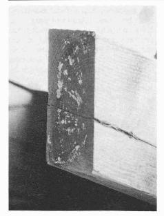
Bild 5. Dachbalken eines Neubaus, der mangels Hygiene auf dem Lagerplatz bereits vor dem Einbau von einem höheren Pilz befallen worden war
