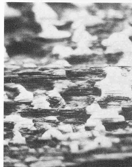
Bild 1. Oberflächliche Holzerosion durch Solarstrahlung, Bläuepilze und Regen
