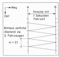
Bild 7. Weg-Zeit-Diagramm für die Einspurstrekke AB. Wenn der mittlere zeitliche Abstand m zwischen zwei Fahrzeugen gerade doppelt so gross ist wie die Fahrzeit t. die ein Auto braucht, um die einspurige Strecke zu durchfahren, könnten die Fahrzeuge oft nur nocht paketweise hin- und herfahren. Die Einspurstrecke würde zum Verkehrshindernis. Also muss m wesentlich grösser sein als 2t
