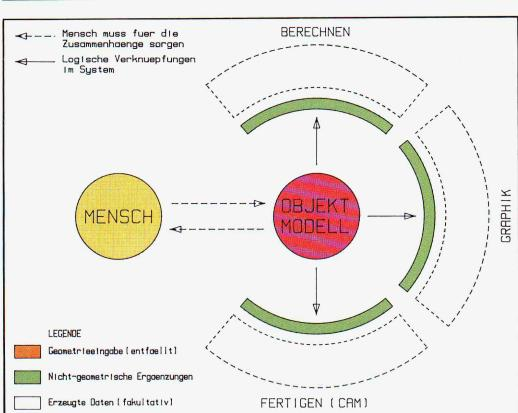
Bild 4. Informationsstruktur CAD-Systemen der 2. Generation. Das vollständige dreidimensionale Computermodell des Objektes wird zur Informationsdrehscheibe und zum zentralen Informationsträger. Graphische Dokumente können bei Bedarf automatisch erzeugt werden
