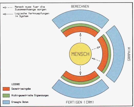
Bild 3. Informationsstruktur CAD-Systemen der 1. Generation. Der Mensch ist Drehscheibe der Information über das Objekt. Die graphischen Dokumente sind zentraler Informationsträger
