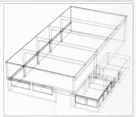
Zentralperspektivische Ansicht eines im Computer als dreidimensionales Modell gespeicherten Bauwerkes. Die graphischen Darstellungen in den Figuren 5 bis 7 wurden mit dem CAD-System der 2. Generation ITS (Interdisziplinäres Technologisches System), das im Laboratorium H. Hossdorf entwickelt wurde, erzeugt. Auch die schematischen Illustrationen im Text sind über das System gezeichnet worden
