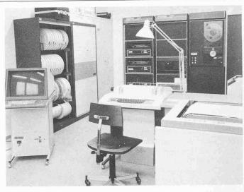
Fig. 4. Mini-ordinateur universel (PDP11-34) avec, entre autres, une imprimante/traceur de courbes électrostatique et un écran graphique
