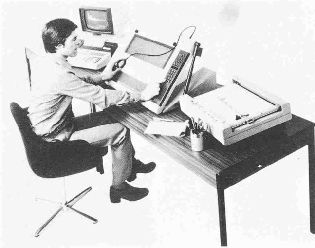
Fig. 3. Ordinateur de table avec traceur de courbes et tablette de digitalisation (HP 9845)
