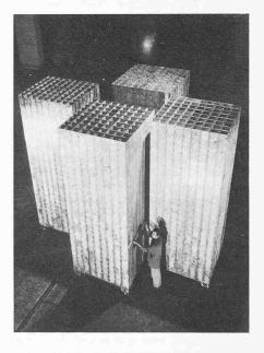
Auflagebolzen oder Träger abgestützt und verankert. Der Einbau von Kompaktlagern in bestehende Kernkraftwerke wird durch das weiterentwickelte System der freistehenden, beweglichen Gestelle erleichtert. Die Kühlung der eingelagerten Brennelemente erfolgt in der Regel durch freie Konvektion über entsprechende Öffnungen in der Grundplatte.
