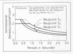
Bild 6. Normalisierte horizontale Schubkoeffizienten ( $A_a = A_v = 1,0$ )
