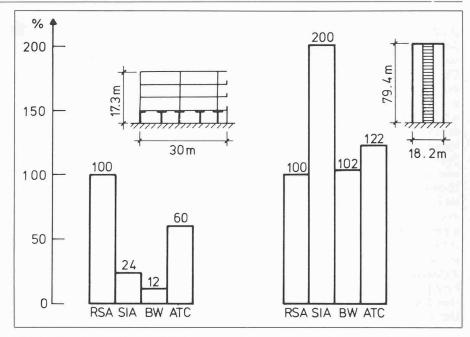
Vergleich verschiedener Erdbebennormen, dargestellt an einem Lagerhaus und an einem Hochhaus. Aufgetragen sind die maximalen Biegemomente aus reiner Erdbebenbelastung am Fuss der linken Stütze des Lagerhauses bzw. am Fuss des Kerns des Hochhauses. Der Wert der Antwortspektrenberechnung (RSA) wird als Vergleichswert zu 100 Prozent festgelegt
