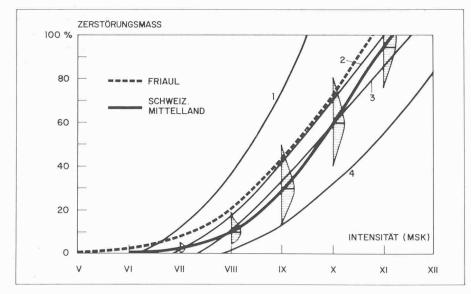
Bild 11. Schadenfunktionen. Das Verhältnis von Schadenwert zu Inventarwert an verschiedenen Gebäudetypen (1–4) und für Regionen in Funktion der Standortintensität (MSK).
