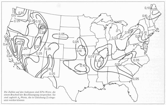
Bild 5. Isohypsenkarte für effektive Spitzenbeschleunigung (EPA)
