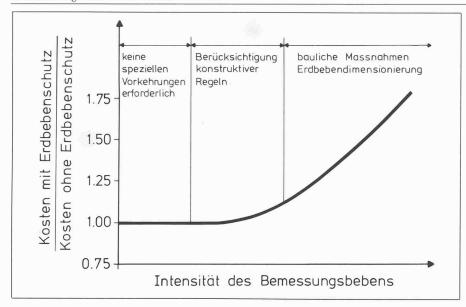
Bild 7. Relative Mehrkosten erdbebensicherer Bauwerke in Abhängigkeit des Bemessungsbebens
