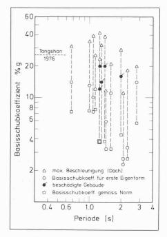
Bild 8. Tragreserve von Gebäuden ausgedrückt durch den Basisschubkoeffizienten (Verhältnis von Horizontalschub zu Eigengewicht). Basisschubkoeffizient von mehrstöckigen Betongebäuden während des San Fernando-Erdbebens vom 9. Febr. 1971. Die Perioden entsprechen der Grundschwingungsdauer der Gebäude. Der Basisschubkoeffizient entspricht dem Verhältnis des Horizontalschubes zur Bauwerksmasse
