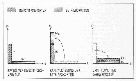
Bild 2. Umformungsmöglichkeiten der Investitions- und der Betriebskosten. Es bedeuten:
