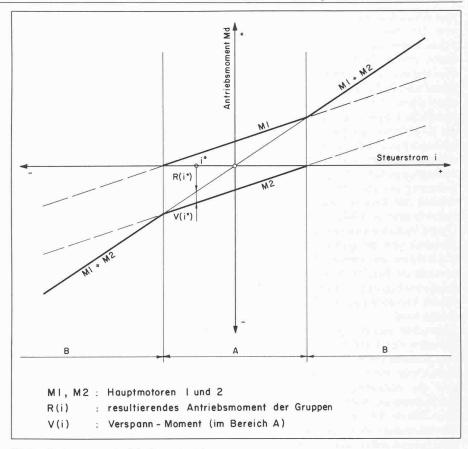
Bild 7. Drehmomentverlauf des Servo-Antriebssystems
