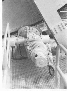
Bild 6. Antriebsgruppen für Azimut- und Elevationsbewegung
