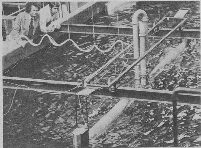
vice wird z. Zt. in Modellform in einem Wellentank der Universität erprobt. Die Betriebsvariante, ein 200 m langer, in Kammern unterteilter, mit Luft gefüllter und mit Schnur verstärkter Gummischlauch, wäre an einem unter Wasser befindlichen Betonrumpf angeordnet. Der 6,5 m breite und 14 m tiefe «Schlauch» wäre am Meeresboden verankert und würde an der Oberfläche schwimmen, wobei etwa 80% unter Wasser wären. Der Schlauch wäre mit seinem
