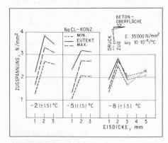
Berechnete Eigenspannungen Kreise) infolge Temperaturschocks an der Oberfläche einer 20 cm dicken Betonplatte [12]
