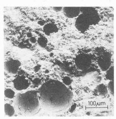
Bild 3. Kugelförmige Luftporen in Beton. Aufnahme einer Betonbruchfläche mit dem Rasterelektronenmikroskop. Beton PC 300, w/z 0,47, 4,4 Prozent Luftporen,  $\beta_{d_{28}} = 39.3 \text{ N/mm}^2$ , 2 Jahre alt [2]
