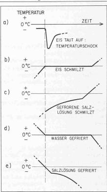
Bild 12. Messungen des Temperaturverlaufs an der Betonoberfläche unter verschiedenen Bedingungen (schematisch dargestellt aufgrund von Versuchen).
