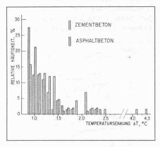
Bild 11. Temperaturschock infolge Natriumchloridstreuung in Zement- und Asphaltbeton; nur Temperatursenkungen von 0,9 °C und mehr sind darge-
