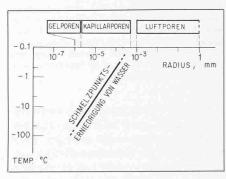
Bild 5. Oben: Porengrössen in Beton Unten: Beziehung zwischen Porengrösse und Schmelztemperatur von Wasser
