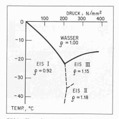
Bild 6. Phasendiagramm H2O, wenn eine Expansion des Wassers unmöglich ist (konstantes Volumen). Die Kurve zwischen den Bereichen «Wasser» und «Eis I» gibt an, wie der Druck in einem abgeschlossenen Hohlraum mit sinkender Temperatur zunimmt. p: Dichte; I, II und III: drei der vielen bekannten Eismodifikationen
